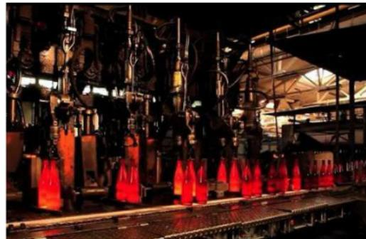
Transformata in cioburi, sticla este apoi amestecata cu nisip, sodiu si calcar si topita in cuptoare, la temperature de peste 1500 gr. C. Apoi este turnata in forme, suflata cu aer si modelata
