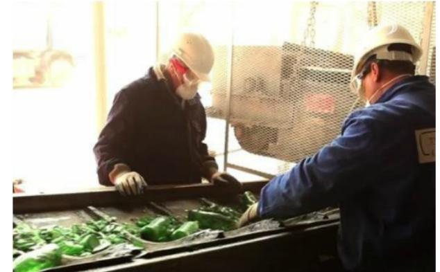
Acestea ajung la statia de sortare unde sunt separate in functie de culoare si trimise apoi spre statii de reciclare
