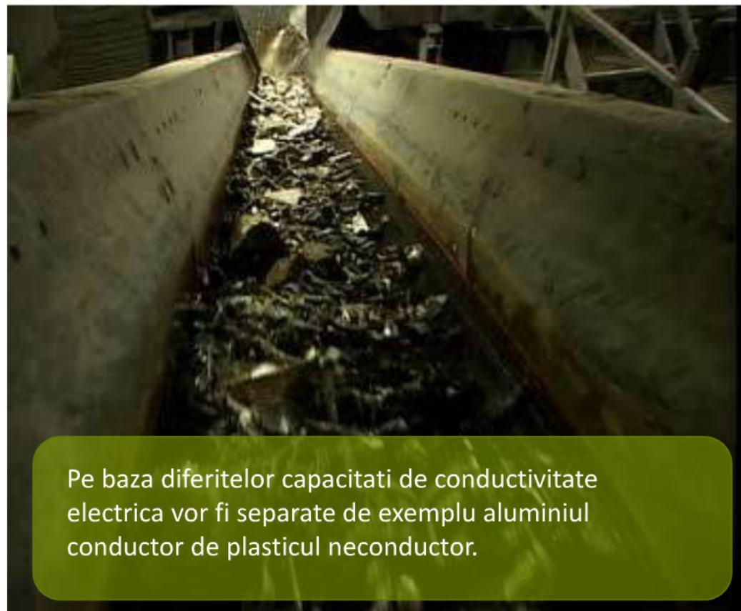
Pe baza diferitelor capacitatii de conductivitate electrica vor fi separate de exemplu aluminiul conductor de plasticul neconductor.
