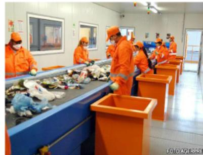
PET-urile ajung la statia de sortare unde sunt separate in functie de culori, de tipologia materialului, gradului de reciclabilitate
