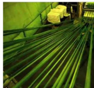
Granulele sunt topite si transformate in fibre sintetice, cunoscute sub numele de poliester
